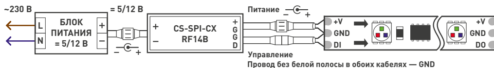
Рисунок 1. Подключение одной SPI-ленты с током потребления менее 2 А.
