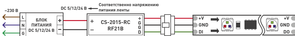
Рисунок 1. Подключение одной SPI-ленты с током потребления менее 2 А.
