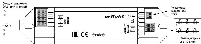
Рис. 1. Подключение диммируемого блока питания
