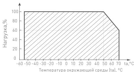
Рис. 2. Максимальная допустимая нагрузка, % от мощности источника.
